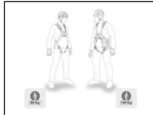
Im Falle eines Sturzes wird der auf die anwendende Person ausgeübte Fangstoß durch das progressive Aufreißen des Gurtbands des Falldämpfers reduziert. Die Verbindungsmitel sind für Anwender/-innen bestimmt, die zwischen 60 und 140 kg wiegen.
